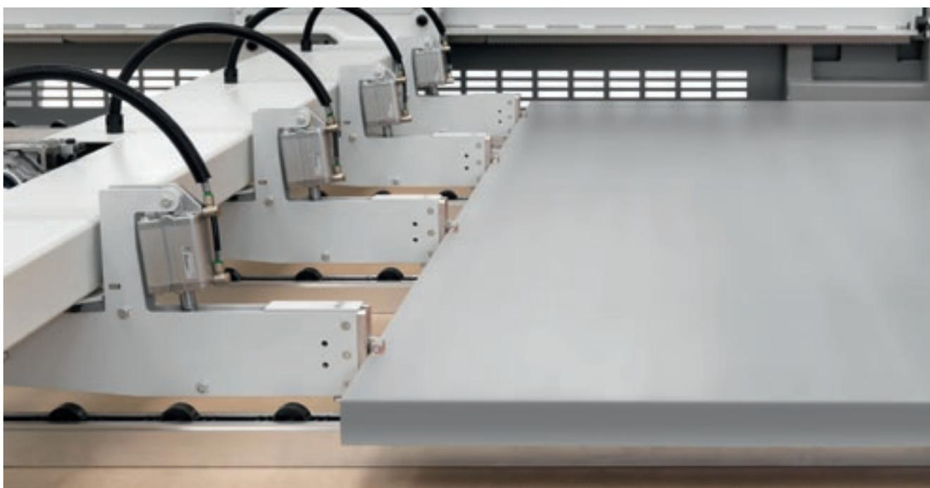
Posicionamento rápido e preciso dos painéis para máxima precisão de corte graças ao carro empurrador robusto acionado por um motor brushless. O plano de deslizamento sob o empurrador possui rodas livres e independentes para evitar riscos em painéis com superfícies delicadas.
